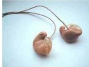
Figura 5. Monitor intraauricolari personalizzati (Fonte: Linee guida europee [1]).
